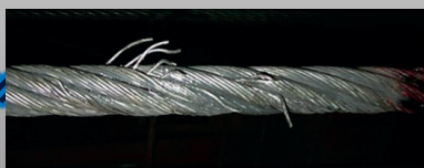
Drahtbruch mit abstehenden Drahtstücken
